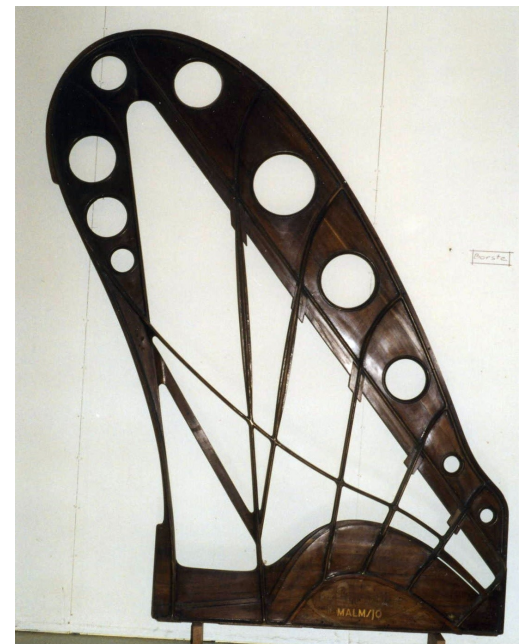
Trämodell till gjutjärnsram för konsertmodellen av Malmsjö's s.k. banansflygel". Modellen gjordes enligt Conny bara i två eller tre serier om tolv exemplar i varje serie. Med sina 3,25 m på diagonalen är flygeln det största instrumentet i Klaverens Hus samlingar.
